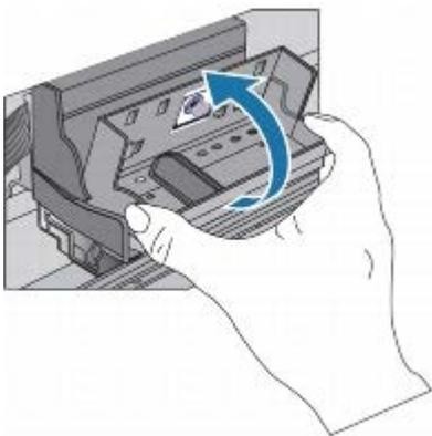
9. Poussez fermement contre le repère cible de la tête d'impression jusqu'au déclic de positionnement.
