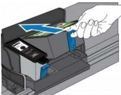
8. Appuyez sur l'onglet jusqu'à entendre un déclic indiquant le positionnement de la cartouche.
